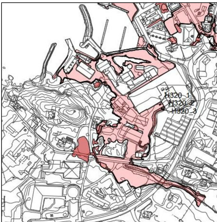
Illustrasjonen til venstre viser avgrensing av fareområde H320, berekna flaumsoner frå bekkar og elvar inkludert klimapåslag. Lysast farge er H320_20, mørkare farge H320_200 og mørkast farge H320_1000. (Norconsult AS)
